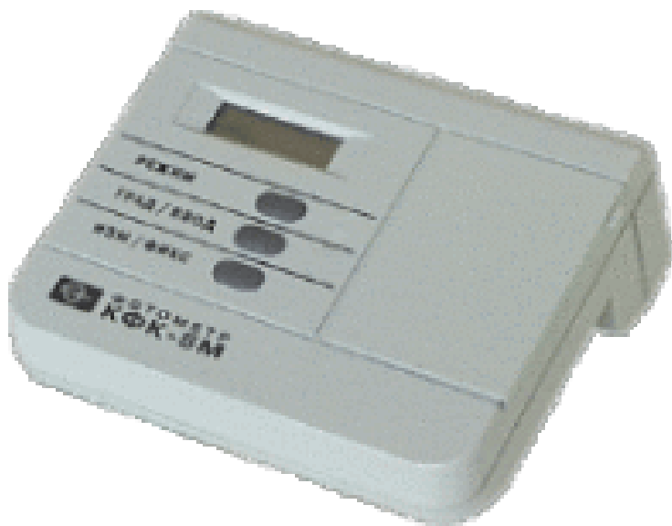
Рисунок 4.4 – Зовнішній вигляд фотоелектроколориметра КФК-5М
