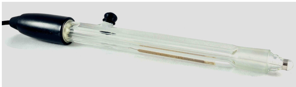
Рисунок 6.3 – Склояний pH -електрод фірми Езодо
