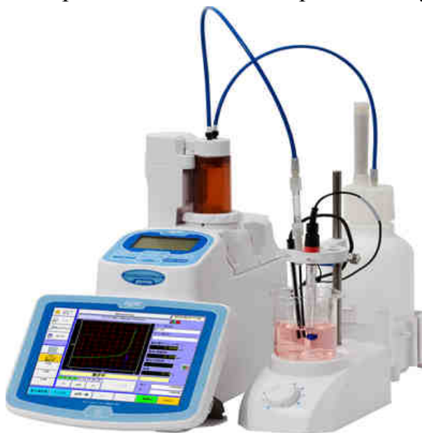
Рисунок 6.20 – Потенціометричний автоматичний титратор АТ-710S
