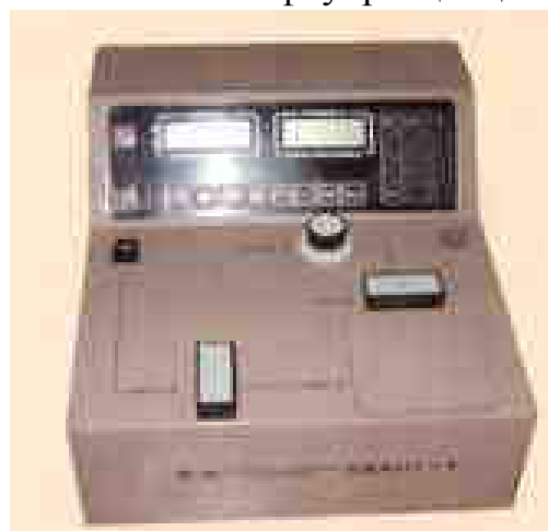
Рисунок 5.6 – Фільтрові флуорометри: а – «ФЛЮОРАТ-02»; б – флуорометр-абсорбціометр «КВАНТ-9»
