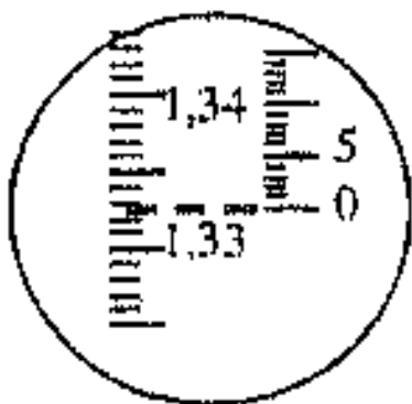
Рисунок 3.4 – Зорове поле рефрактометра під час настройки приладу по дистильованій воді
