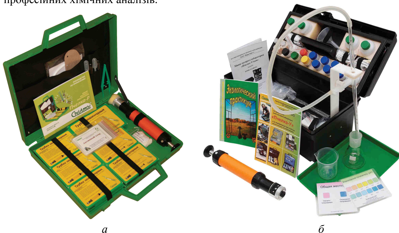
Рисунок 10.6 – Портативна міні-експрес-лабораторії серії «Пчелка»: а – «Пчелка-Р»; б – «Пчелка-У»
