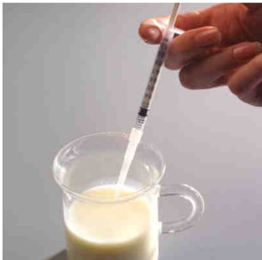
3. Надягніть одноразовий наконечник на шприц. Вижміть поршень повністю, опустіть кінчик піпетки у пробу молока, дозвольте поршню повільно повернутися під дією пружини у початкове положення
