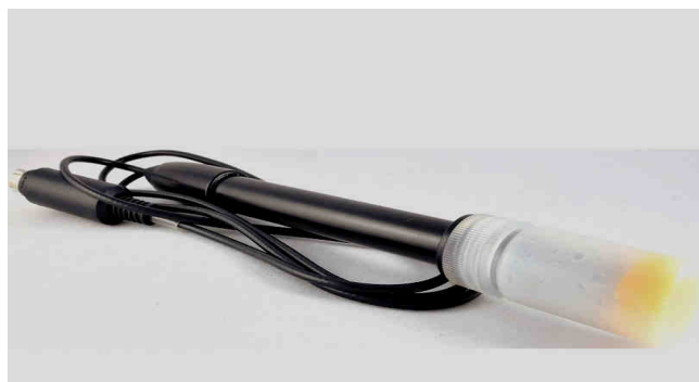
Рисунок 7.7 – Змінні електроди для кондуктометрів EZODO: a – електрод CD60TD7 (функція – солемір); б – електрод DO70D6 (функція – оксиметр)
