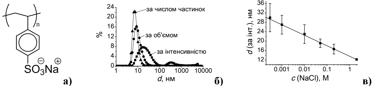
Рис. 2. Структурна формула NaПСС (а); отриманий методом динамічного розсіювання світла розподіл розмірів макромолекул за інтенсивністю розсіювання, об'ємом та числом частинок в 0,001 М розчині NaПСС з добавкою 0,05 М NaCl, d (за інтенсивністю) = 25 \pm 5 нм, d (за об'ємом) = 13 \pm 3 нм, d (за числом частинок) = 7,9 \pm 0,7 нм (б); залежність розміру полііонів (за інтенсивністю) від концентрації NaCl, c (NaПСС) = 0,001 М (в).
